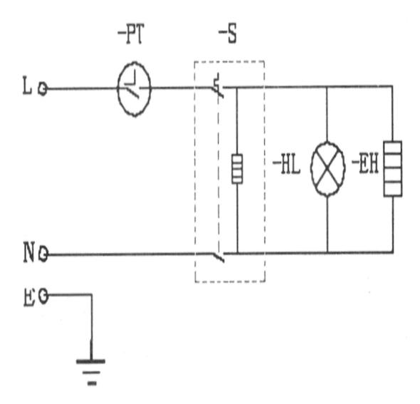
S- Регулятор температуры IIL Лампочка-индикатор РТ- таймер ЕНнагревательный элемент
