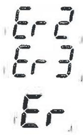
Er2 – термометр обнаруживает быстрые изменения в температуре окружающей среды
